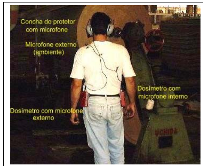
Figura 10: Sujeito vestindo protetor ativo e com os dois dosímetros com microfones externa e internamente
