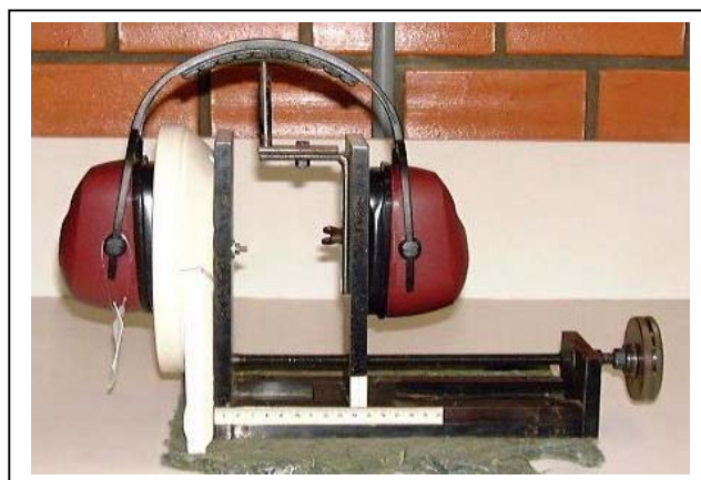
Figura 9: Determinação da força exercida pela arco, conforme ANSI S3.19-1974 (LARI – UFSC)
